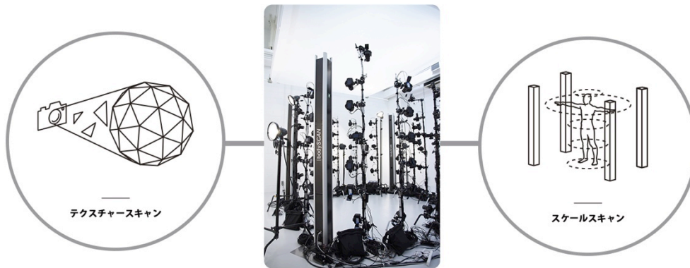
「テクスチャースキャン」と「スケールスキャン」の2つの3Dスキャンシステムを完備
